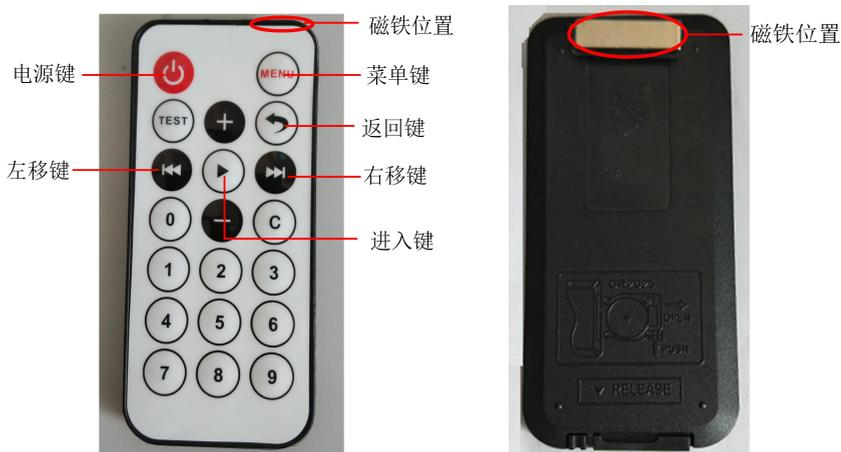
电源键—检定模式转到测量模式
